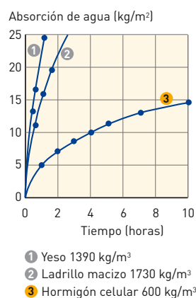
Absorción de agua de diferentes materiales
