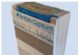
Los muros ofrecen **máximo aislamiento acústico y térmico**. Se colocan tableros de yeso prensado revestidos con pinturas plásticas por la parte interior. Se incluye una cámara con aislantes (manta de roca) cubierta por una envoltura térmica transpirable/impermeable anticondensación. Se añade una cámara de aire, un tablero O.B.S. revestido con acabados a elegir por el cliente.
